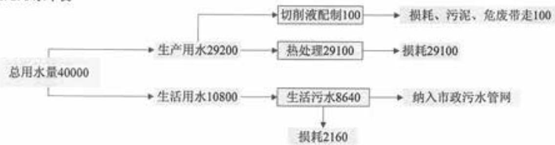
红垦路33号（新厂区）水平衡图 单位：t/a
